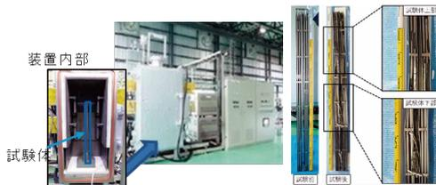
試験後、制御棒ブレードの完全な溶解は無く、上部の溶解物が下部で凝固し、チャンネルボックス間のすき間を閉塞していました。
