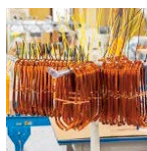
巻かれた銅線はゆがみが一切許されない熟練作業が必要です
