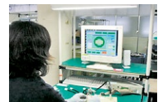
耐圧・誤配・未挿入検査
