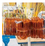
巻かれた銅線はゆがみが一切許されない熟練作業が必要です
