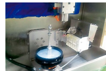
彫刻 フラットエンドミル 微細 素材:マグネシウム アルミニウム ロット:1ヶ~1000ヶ 精度:0.1mm~1/100mm
